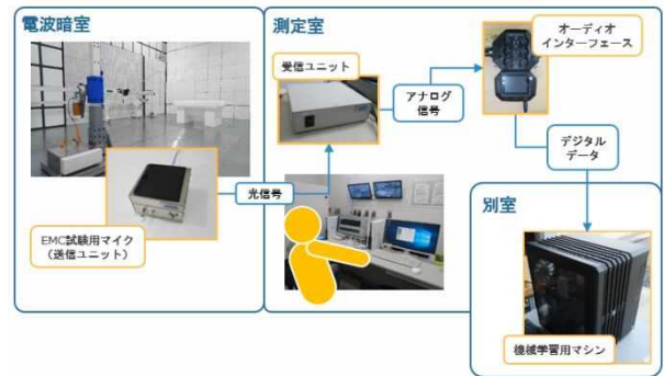
Fig.2 放射イミュニティ試験における録音環境
